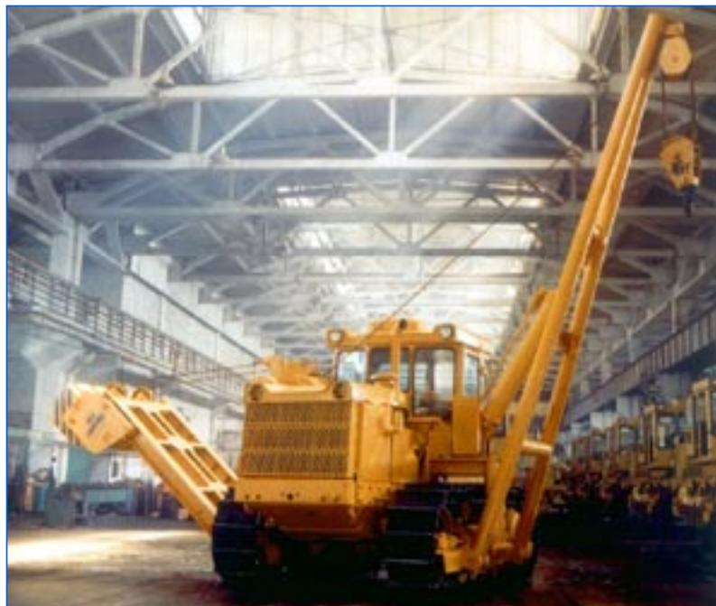
Предназначен для выполнения грузоподъемных операций на строительных площадках, укладке трубопроводов в траншее и на эстакаде.
